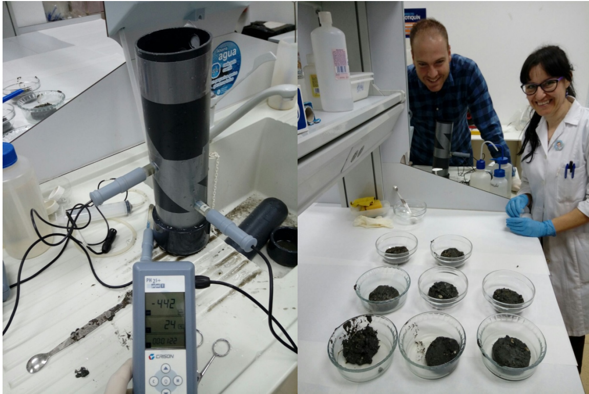
Figura 3. Pruebas de medida de variables fisicoquímicas en los testigos y separación de los sedimentos extraídos de los mismos por profundidades.
