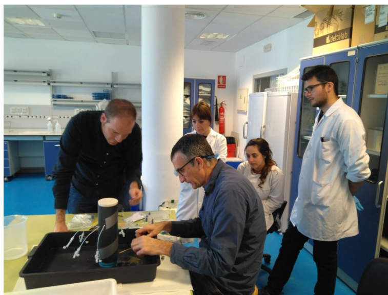
Figura 3. Extracción de agua intersticial de muestras arenosas mediante el uso de Rhizons .
