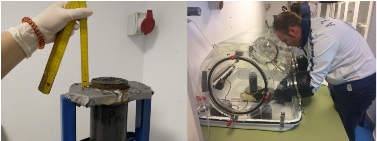
Figura 2. Extracción de las diferentes capas de sedimento y equilibrado de los tubos de centrifuga dentro de la cámara de nitrógeno.
